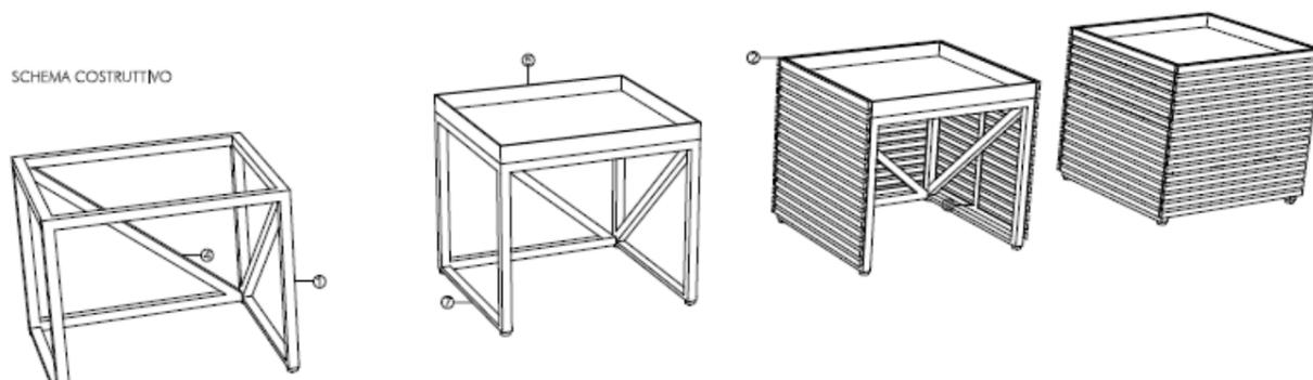
1\_TELAIO METALLICO IN SCATOLARE DI ACCIAIO 70X70 SP. 3MM 2\_LISTELLI DI RIVESTIMENTO IN LEGNO IROKO 50X30 3\_SISTEMA DI AGGANCIO 4\_DIAGONALE DI RINFORZO 5\_FIORIERA 6\_PIASTRA DI FISSAGGIO DEI LISTELLI 7\_SCATOLARE IN ACCIAIO 70X30SP. 3MM
