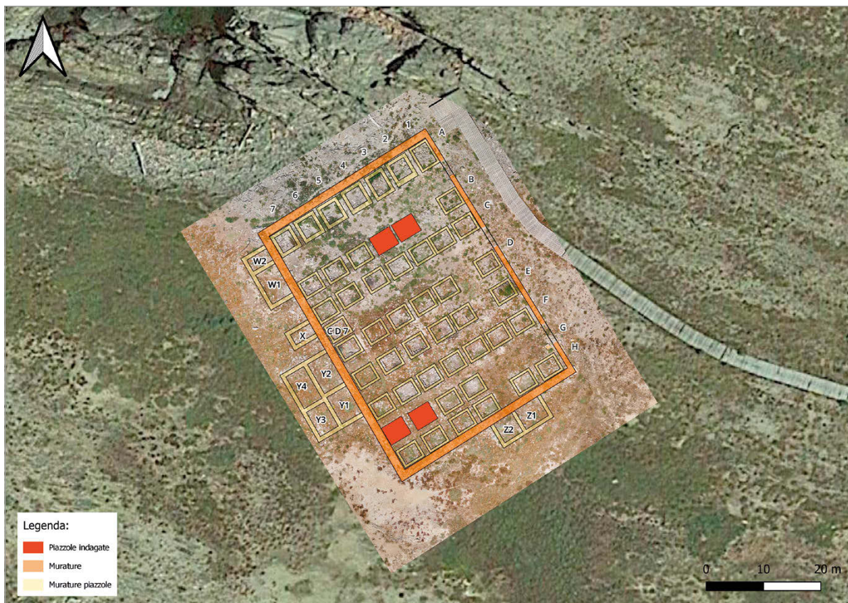
fig. 15 – Planimetria ricostruttiva del campo. Dal Rilievo topografico e fotogrammetrico sono stati ricostruiti le possibili murature perimetrali del campo (colore arancio) e i perimetrali delle piazzole per le tende. Sono stati definiti dei filari quanto più possibile omogenei (lettere e numeri) e sono state posizionate le piazzole oggetto dell'indagine (colore rosso).
